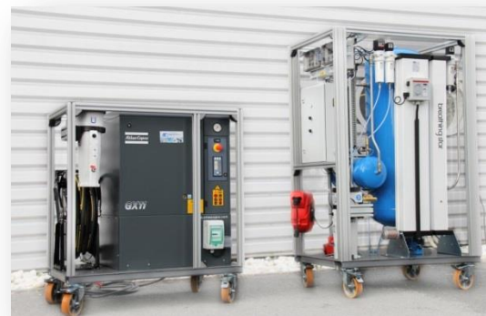
Centrale de production d'air respirable ou d'azote
